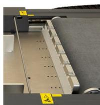
Вакуумные присоски на портале обеспечат надёжную транспортировку любого материала со стола автоподачи на транспортёр с вакуумом
